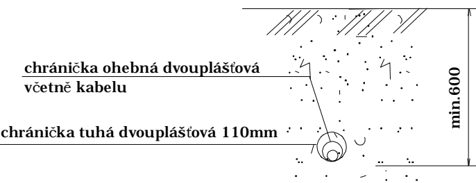
ŘEZ KABELOVOU TRASOU V MÍSTĚ KOŘENOVÉHO SYSTÉMU CHRÁNĚNÉHO STROMU-PROTLAK
